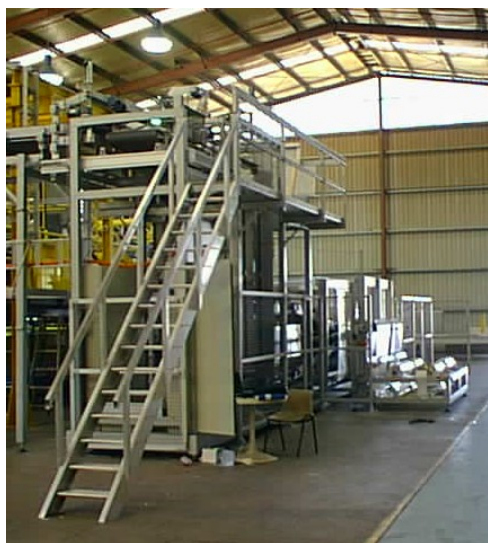
Figur 24 Bild tagen i fabriken i Australien. Till vänster syns staplarenheten och till höger ser man packaren och filmstället.
