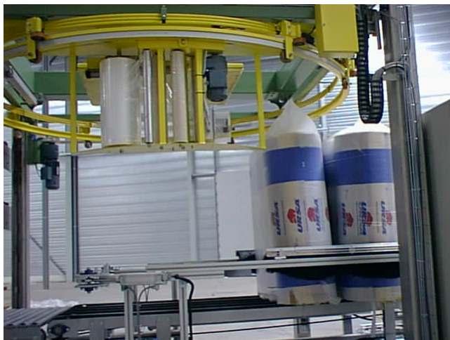
Figur 30 Den så kallade snurrebussen, modul 11, ses här från sidan. Tre multipack med fyra rullar i varje kommer in från höger och stannar under inplastaren som lägger ett antal varv plastfolie runt för att stabilisera innan stapling.
