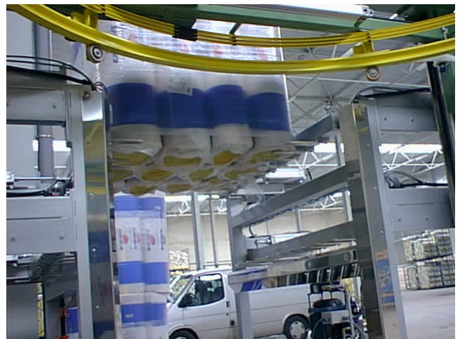
Figur 31 Staplaren, modul 08. Ett lager med rullar är staplat i staplaren och vilar på det övre gaffelparet. I bakgrunden skymtar en färdig pall.
