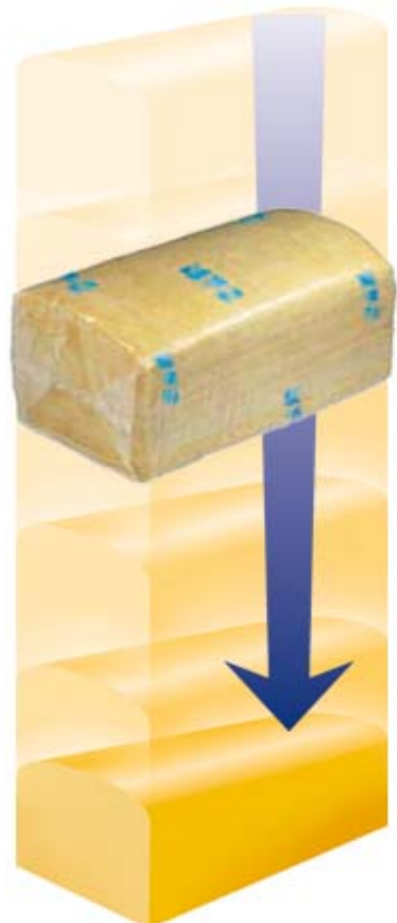
Figur 3 Skivor med låg densitet passar bra för komprimering. Kompressionsgraden kan vara 10:1.
