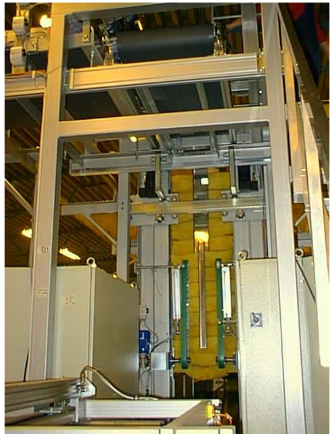
Figur 10 Här är en bild tagen då hela staplarens schakt är fullt. Då rätt antal skivor är staplade kommer komprimeringsvingarna att komprimera stapeln till en höjd på en meter. Därefter fälls de fyra utmatningsbanden ner och stapeln matas mot packaren. Samtidigt har ca sju skivor staplats i nästkommande stapel. Produktionshastigheten är en skiva per sekund.
