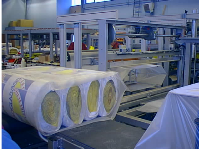
Figur 28 En färdig multipack bestående av fyra rullar ligger på vändbordet. Multipacken vänds så att säckens öppning hamnar nedåt efter uppresning och stapling.
