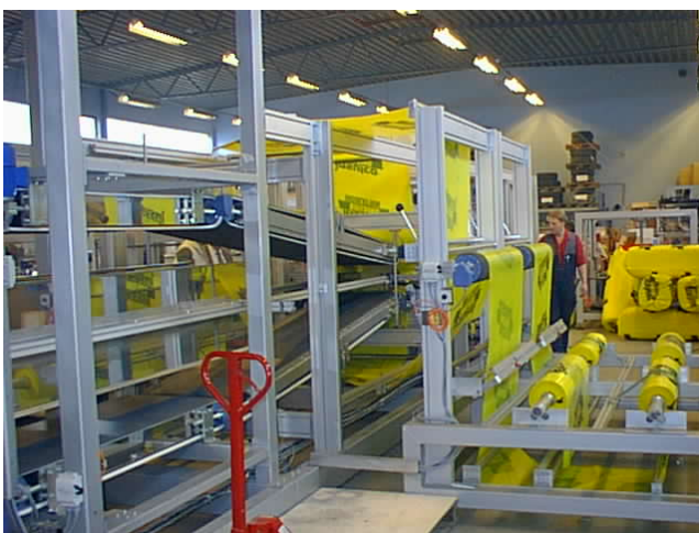
Figur 12 Packarens inmatningstransportörer och komprimeringstransportörer syns till vänster i bilden. Till höger ser man filmrullestället med dubbla rullar till över- respektive underfilm för att man skall kunna skarva filmen under drift. Svetsbackarna för skarvning syns under filmmatningsvalsarna. Längst bort till höger ligger några färdiga paket.
