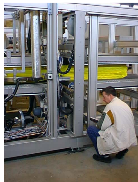
Figur 17 Tvärsvetsningen är här klar och filmen är avskuren. Det högra paketet är färdigt och redo att matas ut
