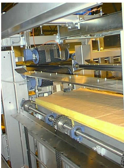
Figur 7 Staplarens inmatningsvalsar, förstaplingsvingar samt paternosterverket.
