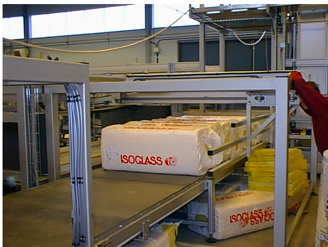
Figur 26 På uppsamlingsbandet, modul 02, ligger fem paket färdiga att skjutas in i komprimeringsmodulen, modul 03.
