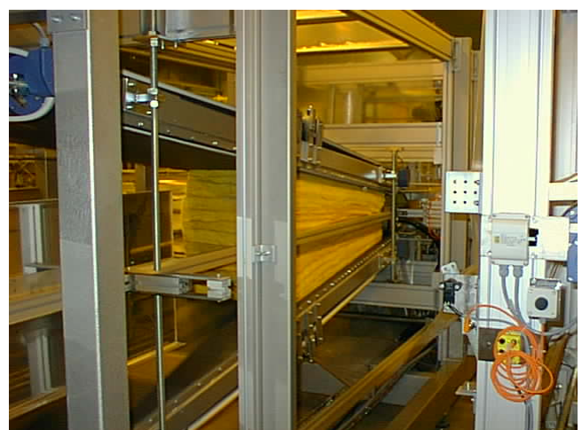
Figur 13 Här visas hur en stapel komprimeras från en höjd på en meter till 400 mm för att sedan matas vidare in i packaren och få plastfilmen om sig. Hela packarens bredd ställs in automatiskt från operatörspanelen likt staplaren.
