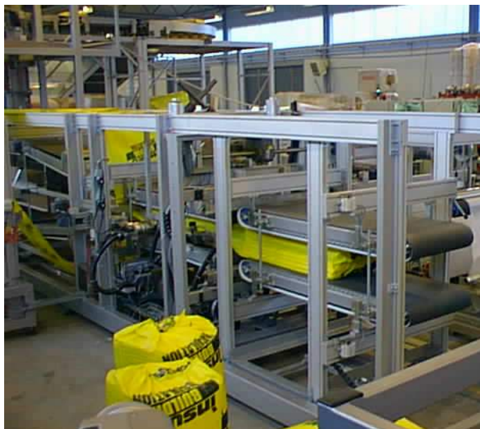
Figur 16 Två paket med en lucka mellan sig är i position för tvärsvetsning. Det främre paketet kommer att backa något samtidigt som övre och undre svetsback går mot varandra.
